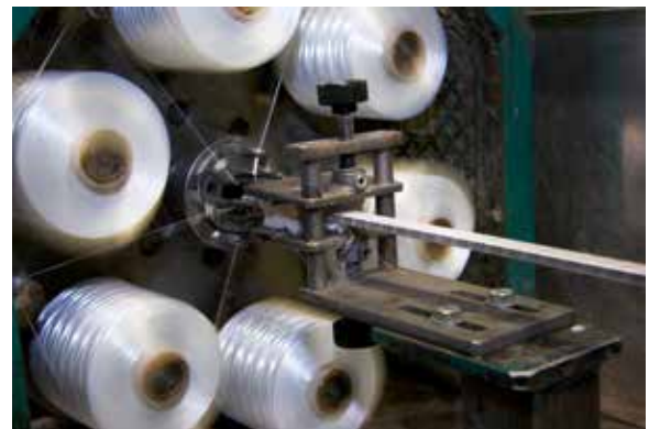
Omspinning av glasfiber
